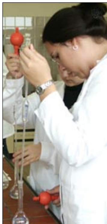
Ana Petrović und Andrea Gehring beim Pipettieren mit Hilfe des orangefarbenen Pipettierballes - in alten Zeiten wurde mit dem Mund gesaugt, heute lernt man schon in den ersten Wochen dieses Hilfsmittel zu bedienen
