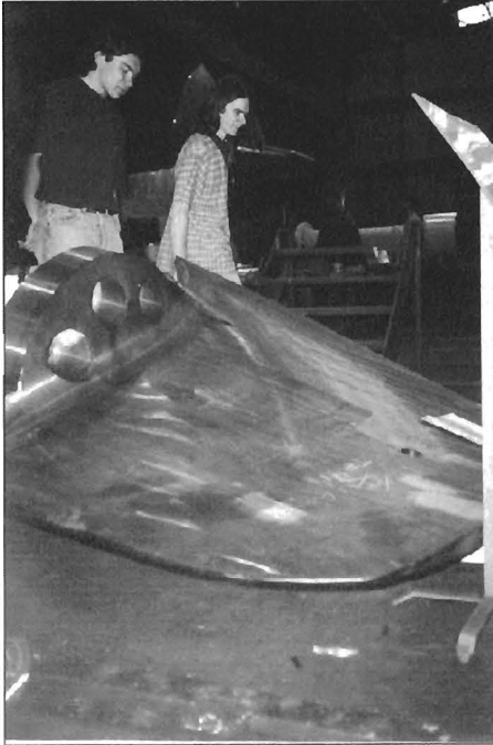
Bei der Voest im Stahlbau bestaunen Riedmann und Auer eine der Turbinen-Schaufeln für das Kraftwerk Freudenu (Laufrad-Durchmesser 10 m!)
