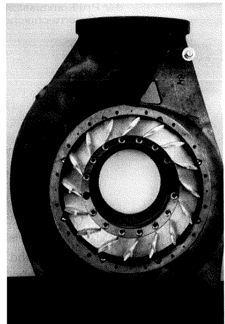
Der Leitapparat der Pumpen-Turbine
