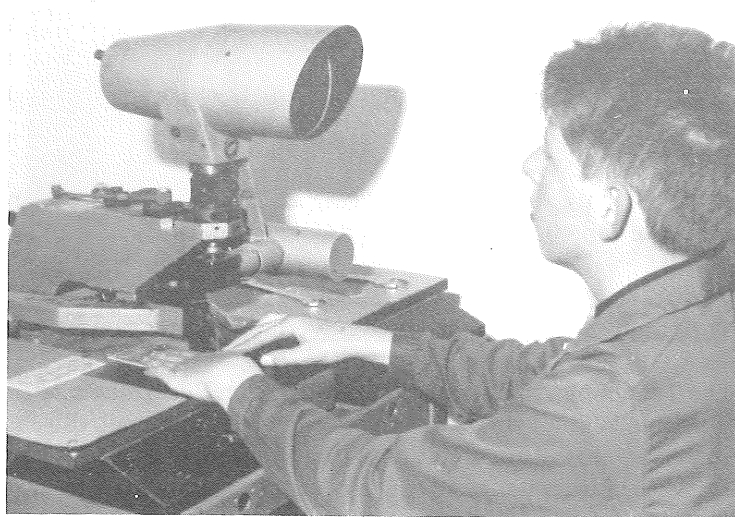
Bohren der Leiterplatte
