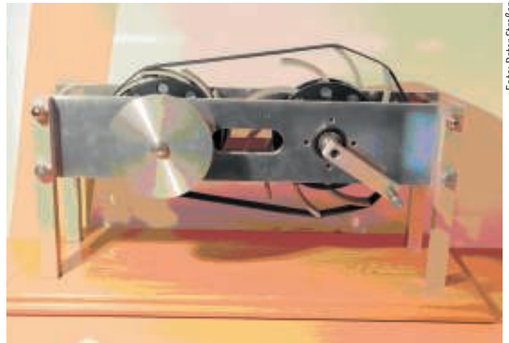
Modell des Fahrrad-Automatikgetriebes von Peter Straßer
