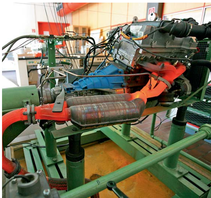
Tests gehören dazu: Am Motorprüfstand kommt das Auspuffrohr ins Glühen
